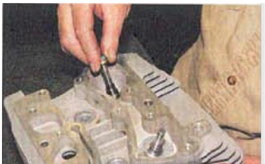
VITON 製バルブステムシールをバルブガイドに挿入。
